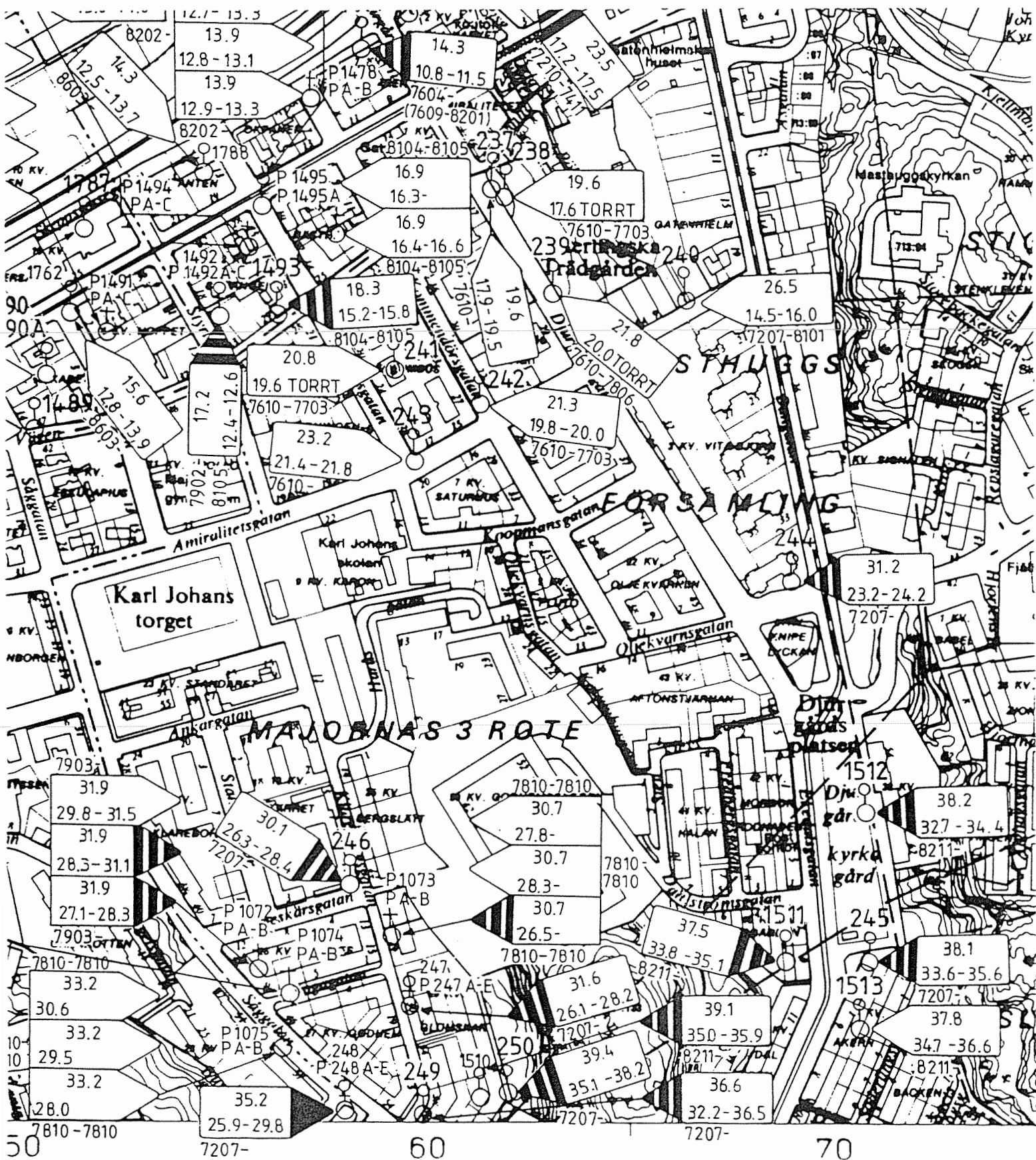
Figur 5 B: Utsnitt från karta visande bedömningar av grundvattennivån i enskilda punkter. Bedömningarna avser normalt (vit pilspets) och lågt (streckad pilspets) grundvattentryck samt kvarstående grundvattensänkning (svart pilspets). Från Gatubolaget, Göteborg.
