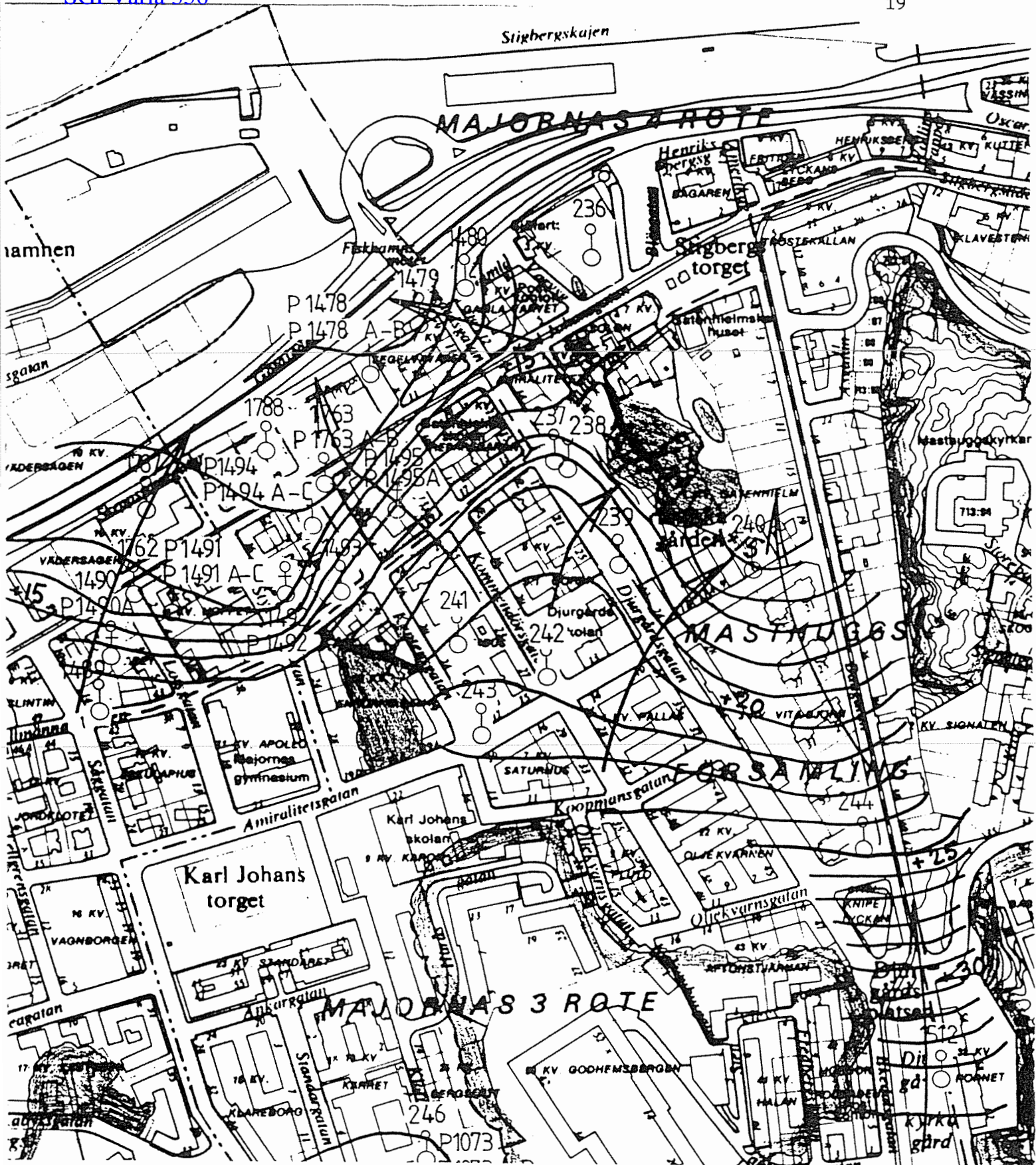
Figur 5 A: Utsnitt från karta visande strömningslinjer samt grundvattennivåer i friktionsjordslagret på berg. Använda värden är medelvärden från en tioårs mätperiod (1978-88) för varje rör. Från Gatubolaget, Göteborg.
