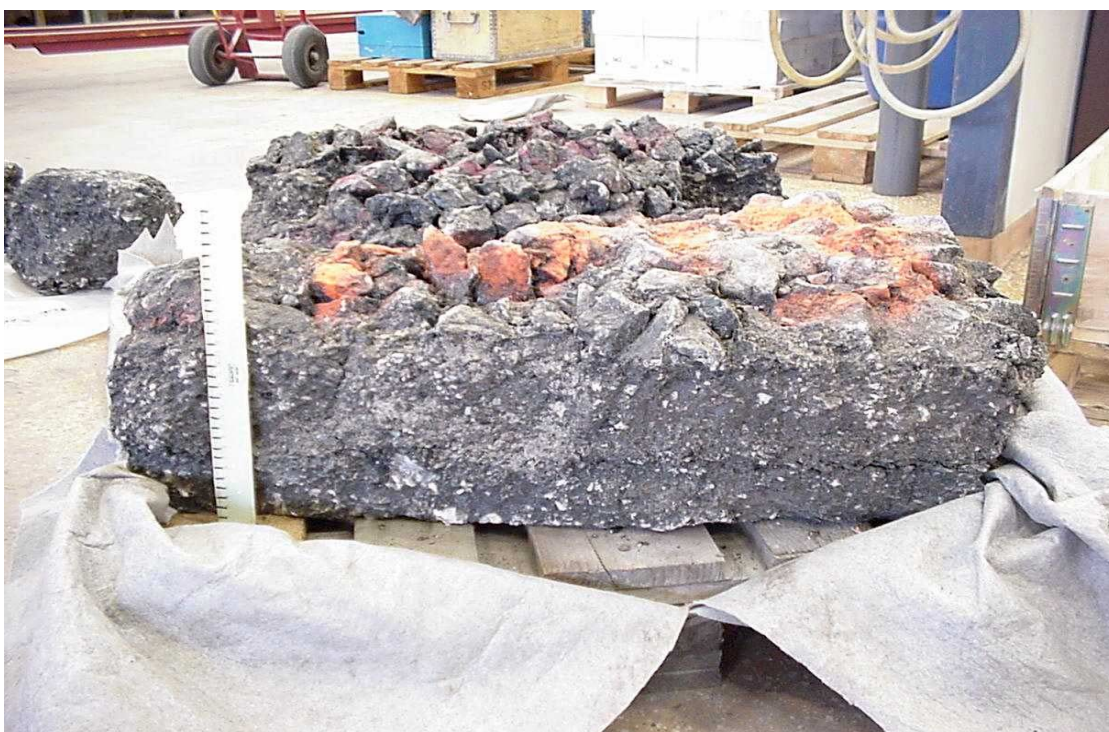
Bild 2. Material 2 närmast (orange markeringsfärg) och material 3 (röd markeringsfärg). Båda ca 100 kg vardera och levererade från Huddingevägen, Södra länken, Entreprenad SL 22. I den övre delen av klumparna syns makadamlagren från vilka prov togs ut till undersökningarna (M2 och M3). Till vänster syns (delvis) även M1.
