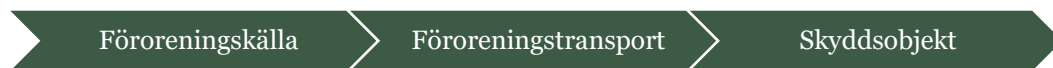
Figur 3-1 Centrala begrepp vid riskbedömning av förorenade områden. I rapporten behandlas även belastning under rubriken föroreningstransport.
